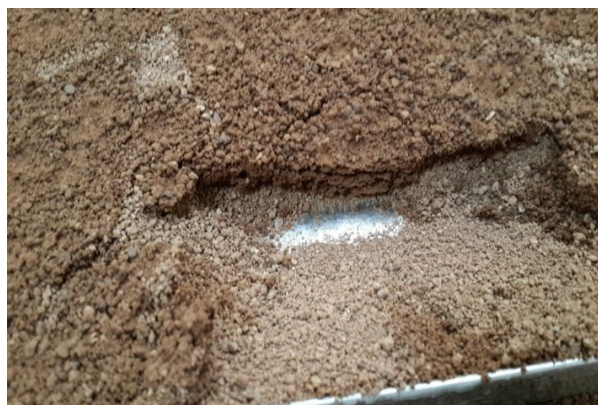
شکل ۱۰. میزان عمق نفوذ محلول‌ها و حرکت خاک به صورت توده‌های منسجم
