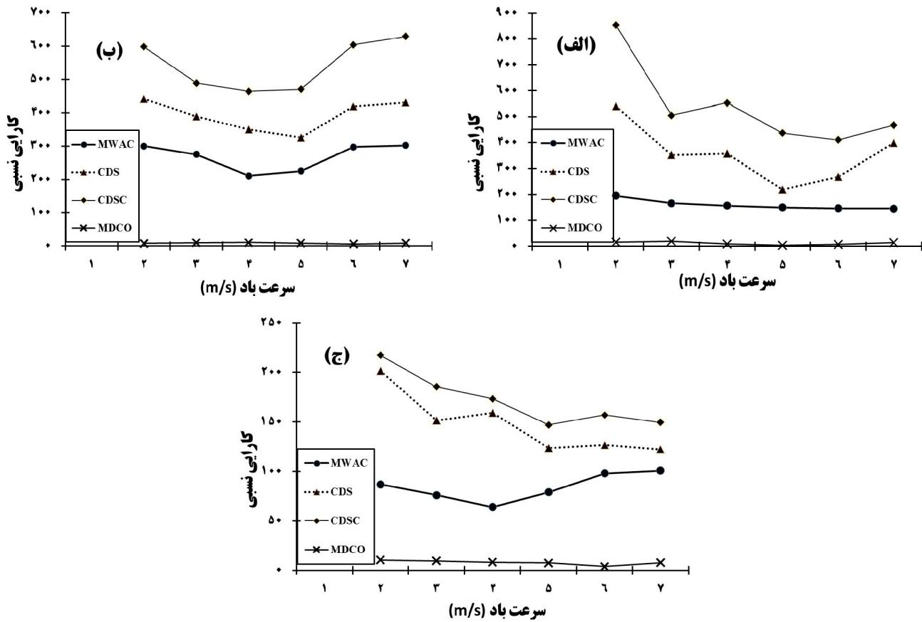
شکل ۳. مقایسه کارایی نسبی چهار تله رسوب گیر MWAC، دورانی با مخروط (CDSC) و دورانی بدون مخروط (CDS) و MDCO در سرعت‌های باد ۲ تا ۷ متر بر ثانیه نسبت به تله رسوب گیر BSNE برای ذرات با  $D_5 = 260 \mu\text{m}$  (الف) (ب) (ج) ۲۰۸ میکرومتر
