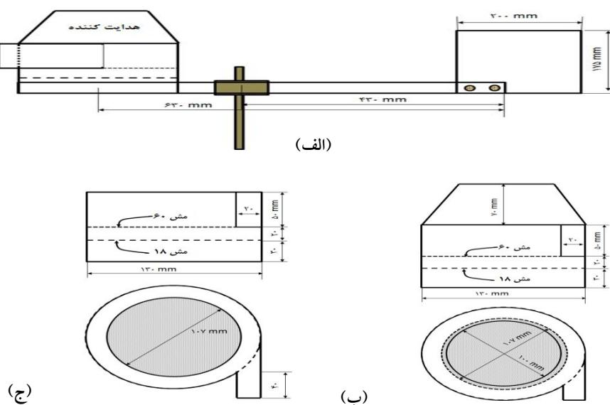
شکل ۲. (الف)، تله رسوب‌گیر دورانی نصب شده روی پایه ب) تله رسوب‌گیر دورانی با مخروط (CDSC) و (ج) تله رسوب‌گیر دورانی بدون مخروط (CDS)
