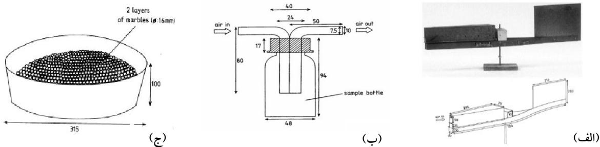
شکل ۱. تله‌های رسوب‌گیر (الف) MWAC و (ج) BSNE (اندازه به میلی‌متر)
