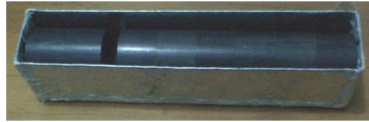
شکل ۱. نمایی از فرآیند انتقال بخار آب از محلول رقیق به محلول غلیظ (چپ) و مدل آزمایشگاهی ساخته شده (راست)
